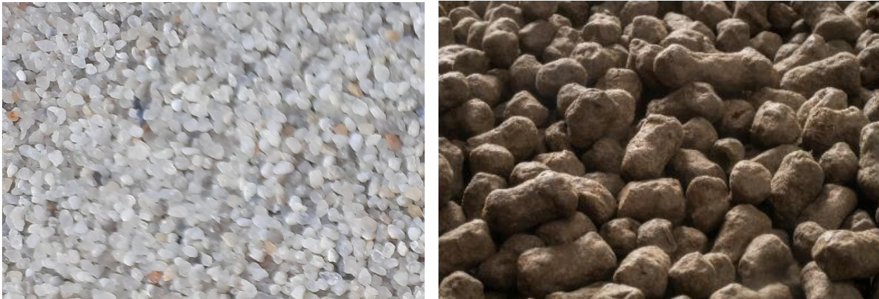
Figuur 5. Omstortingsmaterialen: omstortingsgrind (links) en zweklei (rechts).
